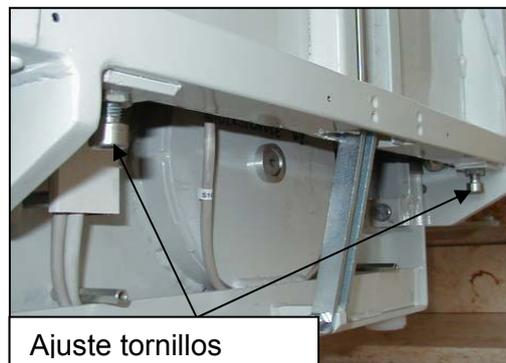
**Precaución:** ¡Comprobar que **ambos** tornillos de ajuste estén soportando la plataforma!
