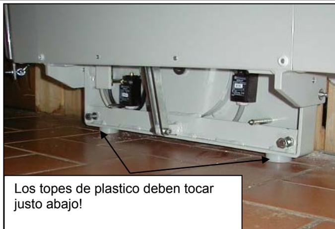
Los topes de plástico en la parte inferior de la parte trasera del carro deben tocar justo el suelo en la **posición inferior de parada**. ¡La unidad del límite inferior se debe colocar de acuerdo con ello!
